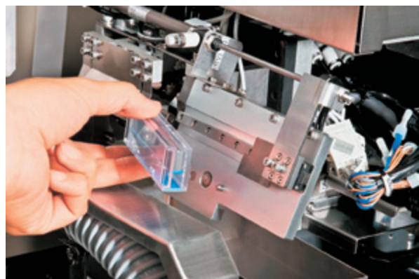
図6 替刃カセットの取り付け
