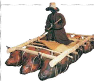
●チュチャワ(羊皮の筏) [中国・20世紀後半] チベットの人々が川を渡るために使用した筏です。羊の皮をふくらませた袋をいくつも取り付け、浮力を生み出しています。
